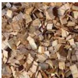
Hackschnitzel sind maschinell zerkleinerte Holzstücke. Sie werden aus Durchforstungsholz, aus Sägenebenprodukten und aus Industrierestholz produziert.
