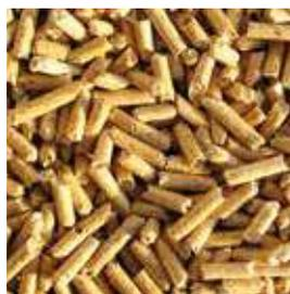
Holzpellets sind kleine, zylindrische Presslinge aus naturbelassenem Holz. Zur Herstellung dienen hauptsächlich Sägereste und Späne der Holzverarbeitenden Industrie.
